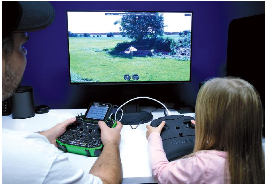
Interessanter Ansatz: Der Stickmover lässt sich für Flugschulungen auch an eine Fernsteuerung koppeln.
